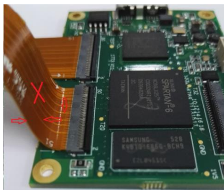
图 3-7 采集板 FPC 线 FPC 座附近禁止外力示意
