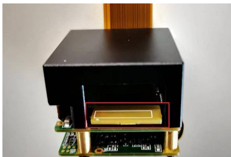
图 3-19 FPC 软线和采集板连接
