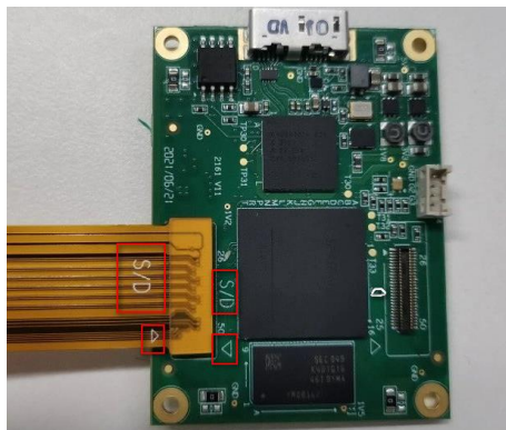
图 3-5 FPC 软线的标签和采集板连接器的标签
